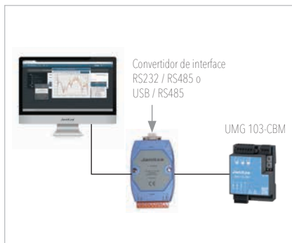
Conexión de un UMG 103-CBM a un PC a través de un convertidor de interface
